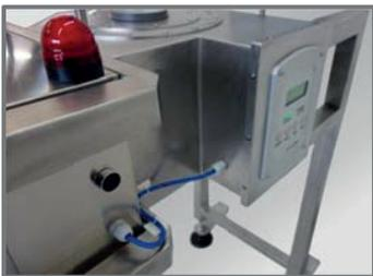
Les Détecteurs de Métaux **MDF série C** peuvent être assemblés pour passage en chute verticale ou pour passage dans des tuyaux inclinés. Fabriqué spécifiquement pour le contrôle des produits granulaires, farine ou mélanges de farines qui passent dans les tuyaux.
