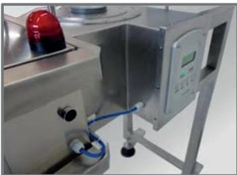
Los detectores de metales **MDF serie C** pueden ser armados para el paso del producto en caída vertical o para el paso en tubos inclinados. Especialmente diseñado para el control de productos granulares, harinas y pequeñas partículas (en polvo) que pasan dentro de tubos.
