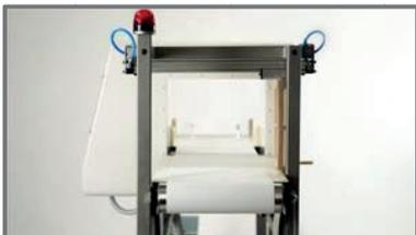
El detector de metales **MDF** ha sido proyectado para ser instalado sobre bandas transportadoras. Como alternativa también podemos ofrecer solo el cabezal de relevación para la instalación en dispositivos externos o bandas pre-existentes.
