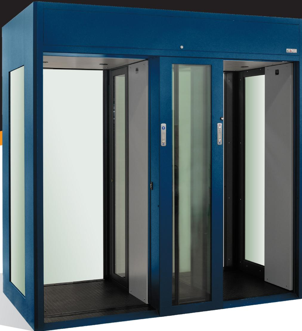
Puerta antiasalto autogestionada de hojas curvas con detector de metales de alta sensibilidad incorporado en su estructura. Sistema de unicidad de transito al ingreso y antirehén en salida. Completamente programable por el usuario.
